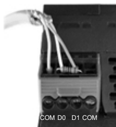
Fig. 10: Borne del módulo del bus de campo (Modbus RTU), resistencia terminal
